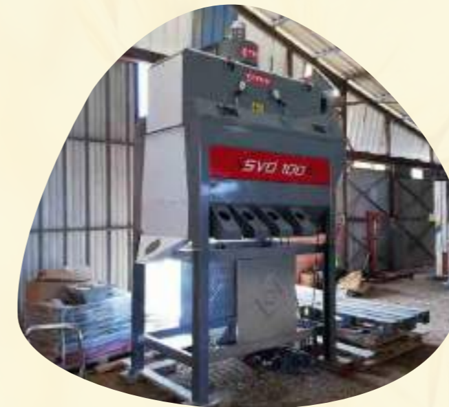
Figure 18 • Séparateur vibrant SVD 100
