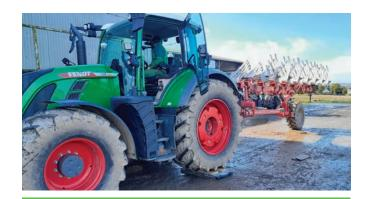
La cuma réalise ses chantiers de labour avec une charrue 7 corps monoroue Grégoire Besson et un tracteur de 200 cv. La charrue travaille en 16 pouces soit une largeur de travail de 2m85. Le tracteur de série légère est équipé de masse de roue de 300 kg par roue arrière et une masse avant de 1,450 T. Les pneumatiques du tracteur sont à l'arrière 650/65R42 gonflés à 1,2 barre et à l'avant 600/65R28 gonflés à 1 bar.
