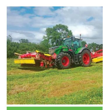
La réactivité et la recherche de qualité face aux fenêtres météorologiques ont été les éléments déclencheurs de l'investissement. La cuma dispose d'un groupe de fauche Pöttinger Novacat X8 ED acheté d'occasion en 2022 en 8m30 avec entraînement des tapis par centrale hydraulique et conditionneur à fléaux
